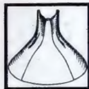
Links: Abb. 3. Das Spannungsgefälle im Anzeigeteil. Die Spannung des Anzeigegitters ist negativ. Die Spannung der positiven Stäbe hat einen ziemlich hohen Wert. Die nicht schattlerte Fläche veranschaulicht das Elektronenstrahlbündel.
