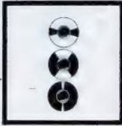
Links: Abb. 1. Anzeigeteil und Verstärkerteil der Abstimmmanzeigeröhre. Oben sehen wir die Kappe, die die Innenteile für den Beschauer verdeckt, inmitten des aufgeschnittenen Leuchtschirms. Darunter sind sichtbar die beiden positiven Stäbe und das Anzeigegitter, das die Kathode umschließt. Die positiven Stäbe stehen mit der Verstärkeranode in Verbindung.
